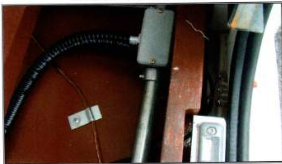
Figura 26 – Parte interna do container após ensaio de jato de água (inexistência de água em seu interior)
