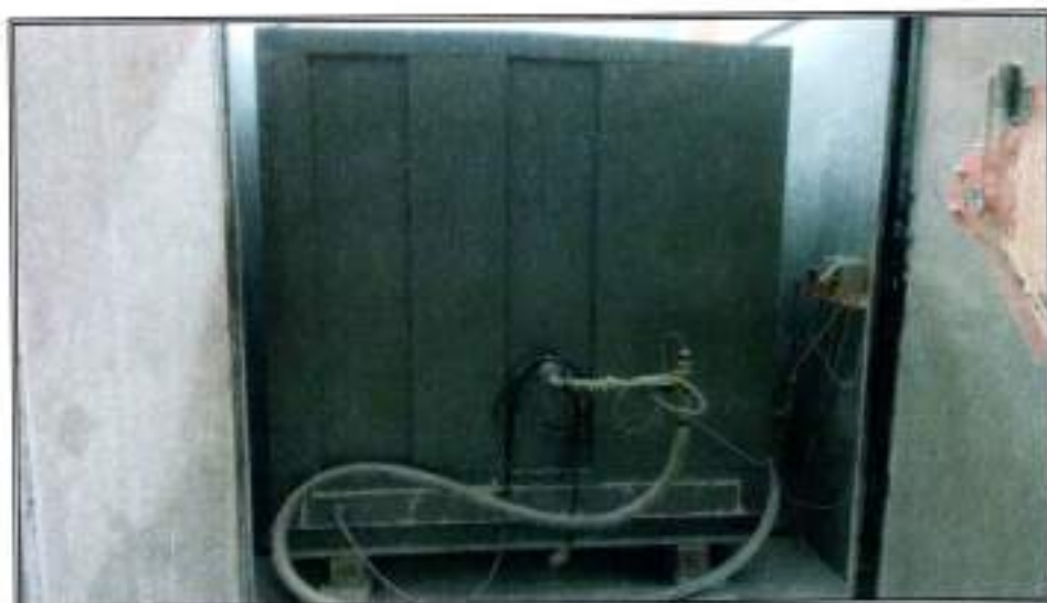
Figura 30 - Modelo reduzido do container no interior da câmara de poeira
