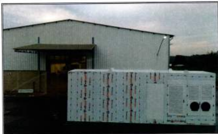
Figura 14 - Ensaio de jato de água no container nas instalações industriais
