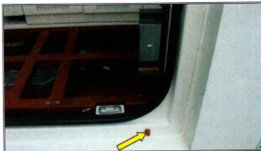
Figura 15 – Parte interna do container após ensaio de jato de água potente e detalhe do capuz de borracha no atuador do micro - interruptor. (inexistência de água em seu interior)
