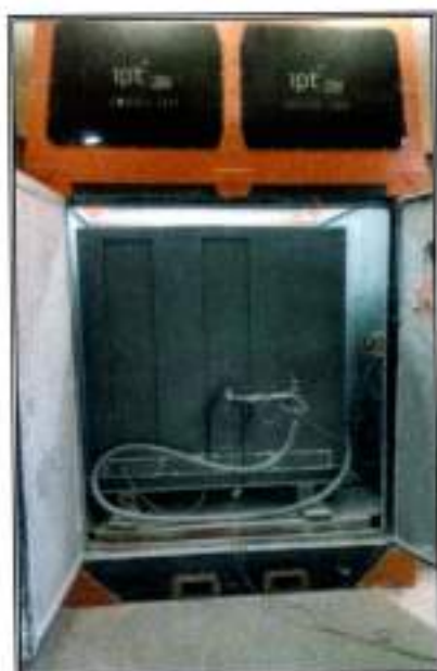
Figura 28 – Modelo reduzido do container no interior da câmara de poeira
