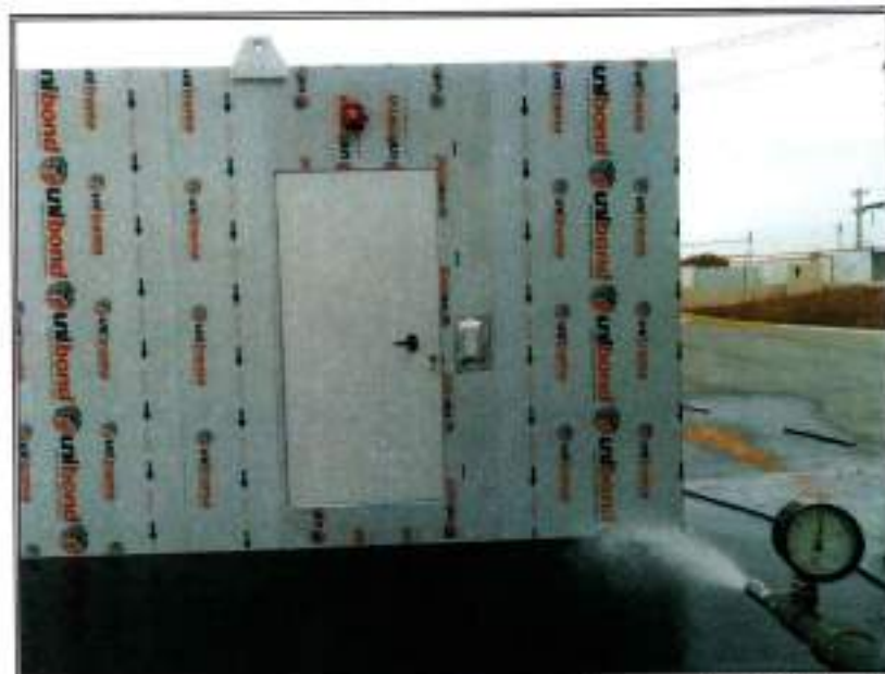
Figura 10 - Ensaio de jato de água potente no container nas instalações industriais
