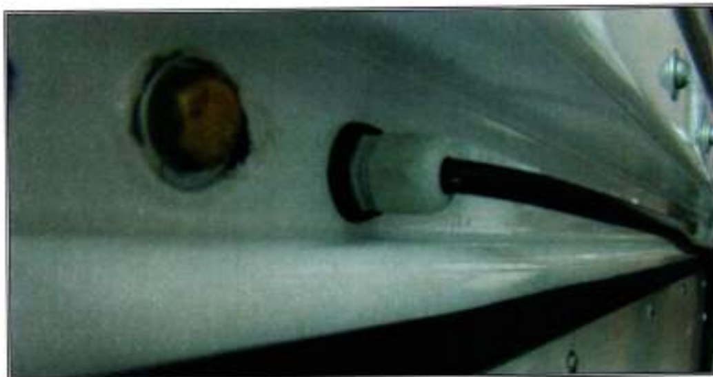
Figura 22 – Parte interna do container após ensaio de jato de água (inexistência de água em seu interior)
