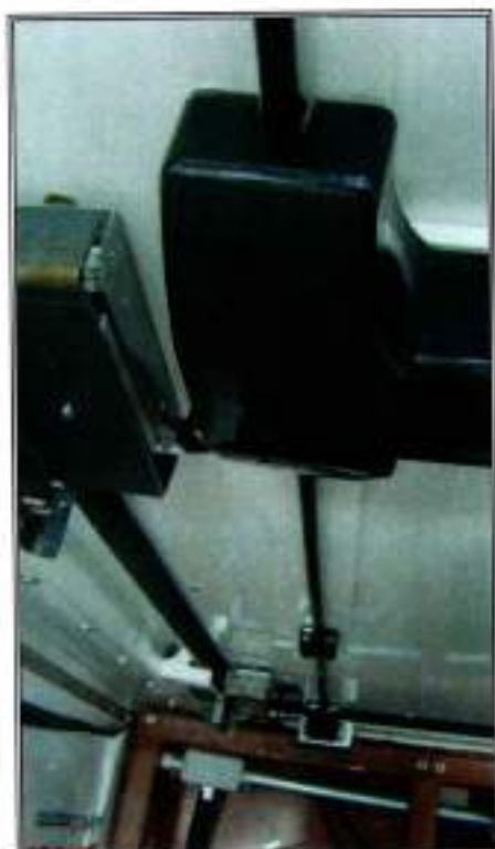
Figura 23 e Figura 24 – Partes internas do container após ensaio de jato de água (inexistência de água em seu interior)
