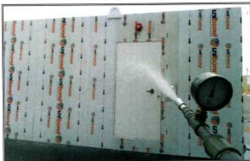
Figura 11 - Ensaio de jato de água potente no container nas instalações industriais
