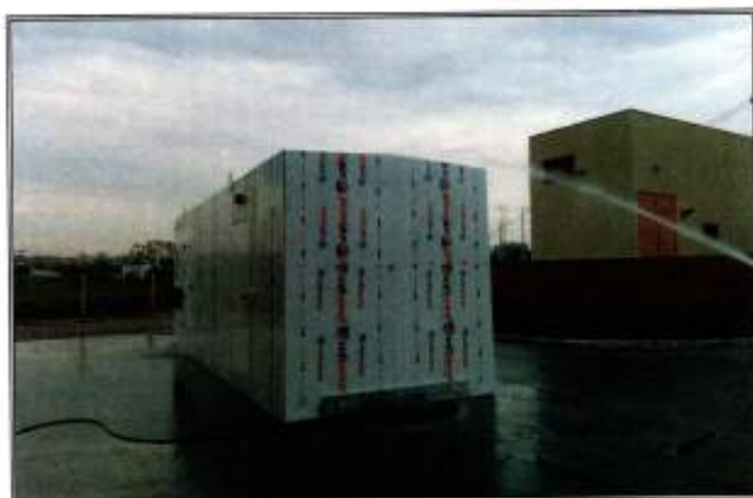
Figura 13 - Ensaio de jato de água potente no container nas instalações industriais
