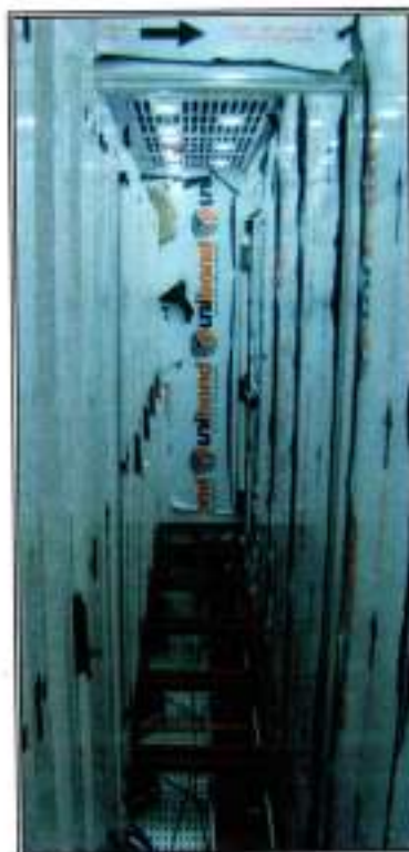
Figura 23 e Figura 24 – Partes internas do container após ensaio de jato de água (inexistência de água em seu interior)
