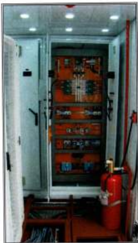
Figura 25 – Parte interna do container após ensaio de jato de água (inexistência de água em seu interior)
