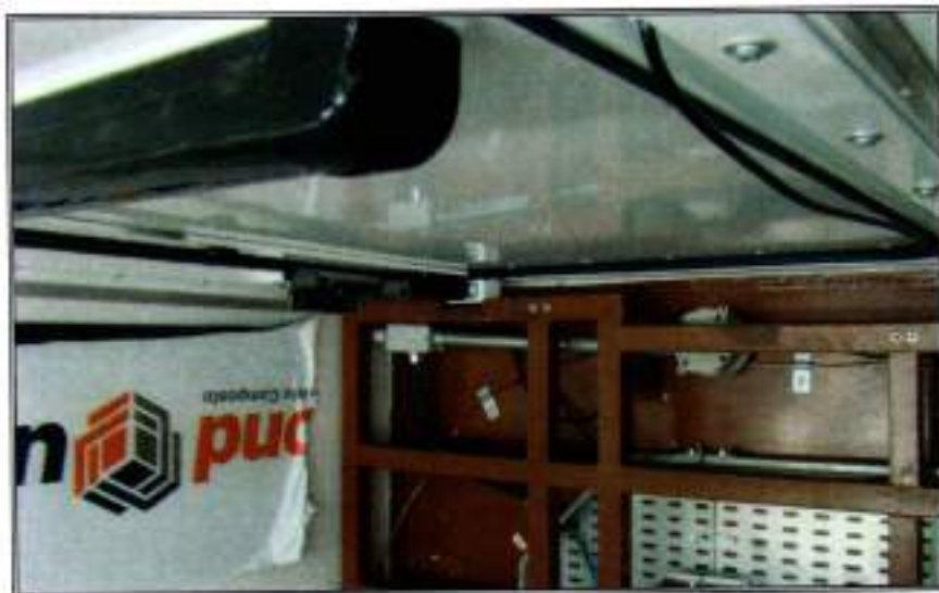
Figura 21 – Parte interna do container após ensaio de jato de água (inexistência de água em seu interior)
