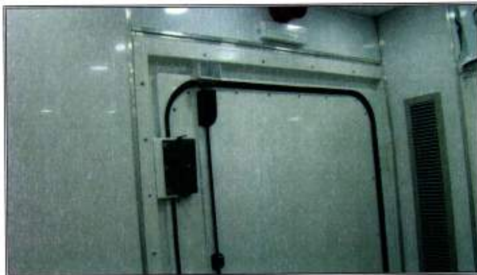
Figura 19 – Parte interna do container após ensaio de jato de água (inexistência de água em seu interior)
