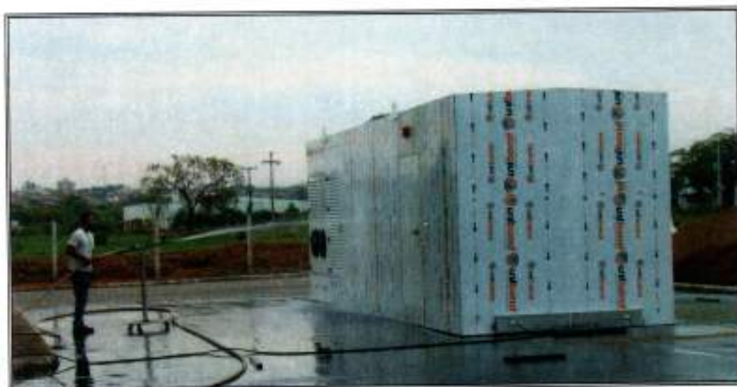
Figura 9 – Ensaio de jato de água potente no container nas instalações industriais
